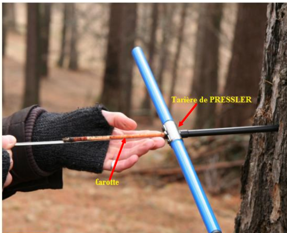
Figure 29. Mesure de l'âge d'un arbre par la tarière de PRESSLER
