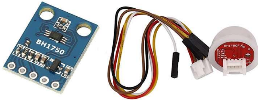
Figure III-22 Capteur d'éclairément BH1750
