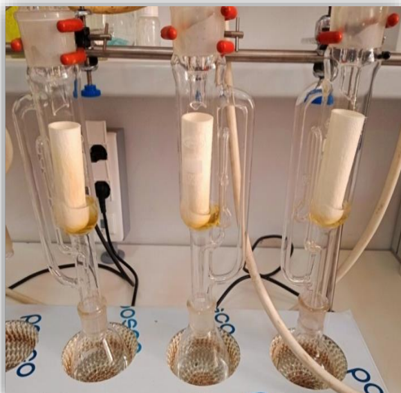
Figure 15: Montage de l'extraction méthanol, sous soxhlet.
