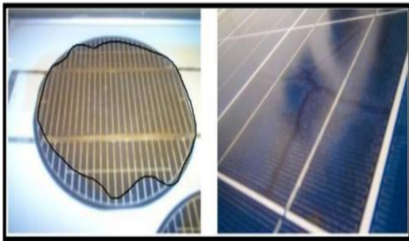
Figure (II.4): Modules photovoltaïques avec des cellules décolorées.
