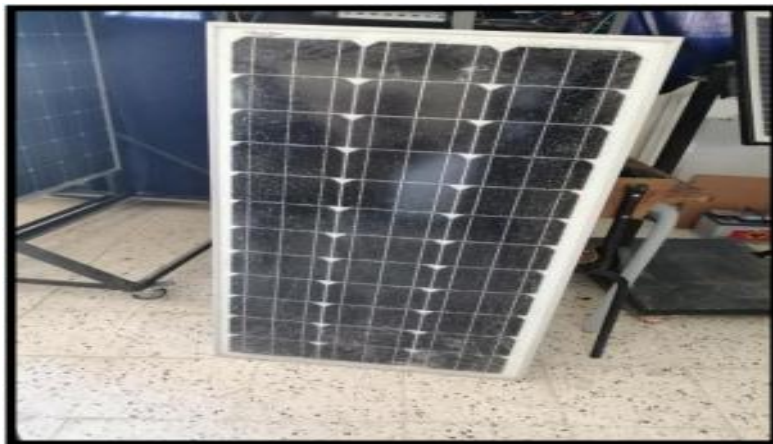
Figure (II.5): Module photovoltaïque présentant des bris de verre [30].
