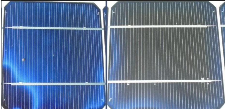
Figure II-6: Détérioration du revêtement anti reflet (ARC) [9].
