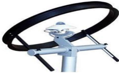
Figure I.3 : Appareil de mesure des rayons diffus (pyrano-mètre). [11]
