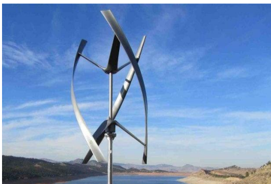
Eolienne de type darrieus
