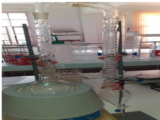
Figure IV. 3. Montage de Clevenger.
