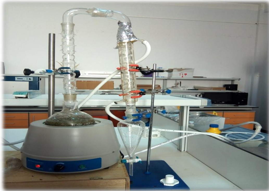
Figure 20 : hydrodistillateur pour l'extraction de l'huile essentielle.
