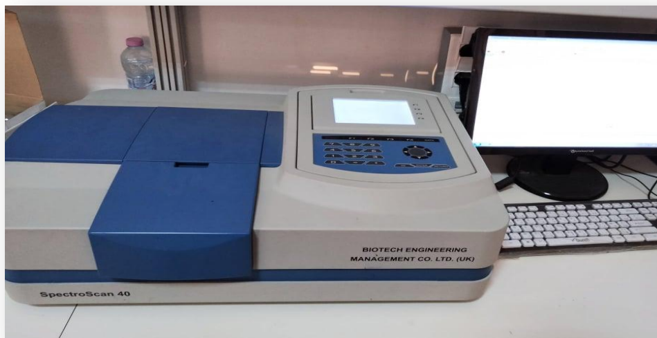
Figure 21 : Analyse spectrophotométrique UV-visible à 517 nm.
