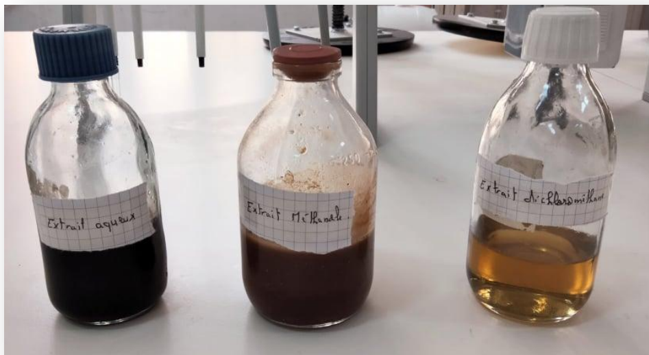
Figure 09 : L'extrait de marc de café par soxhlet avec différents solvants.
