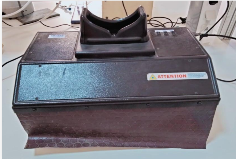
Figure 10 : La chambre noire pour la révélation des substances sur CCM (Lampe UV 365nm et 254nm).
