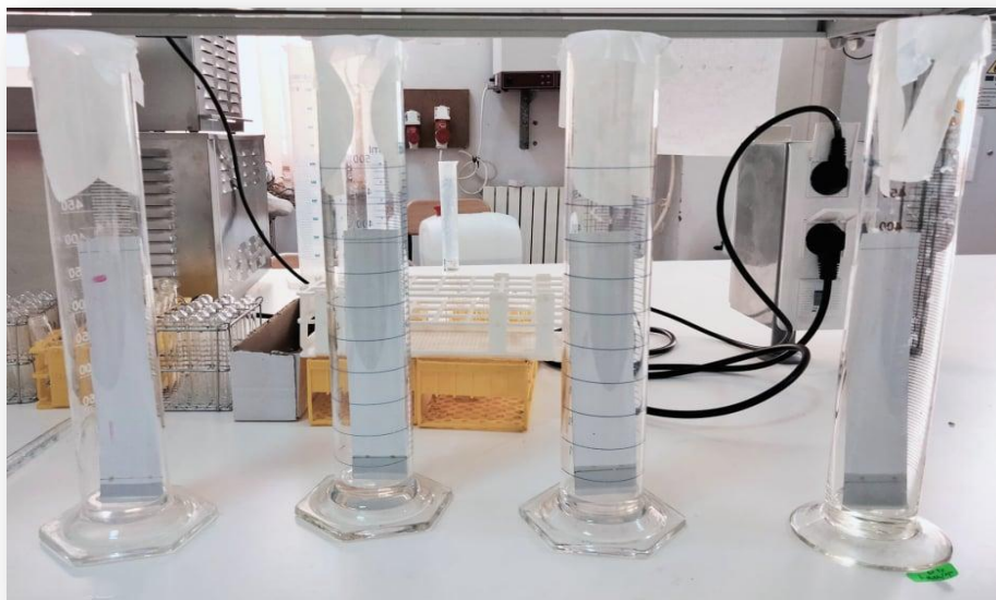
Figure 11 : La mise en contact des plaques CCM avec le solvant polaire
