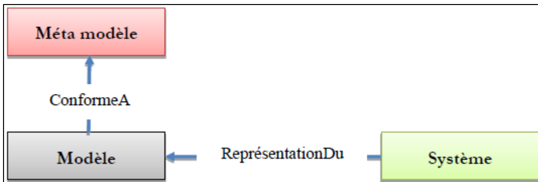
Figure 12 Relations entre système, modèle et méta-modèle (Bézivin, 2004)
