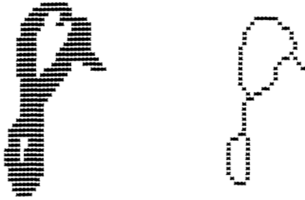
FIGURE 1.5 – squelettisation de chiffre 8
