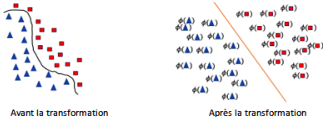
FIGURE 2.7 – L'idée de base du fonctionnement du kernel [38]
