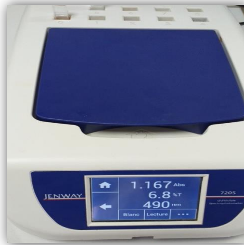
Figure 36. Spectrophotomètre UV 7205 JENWAY.
