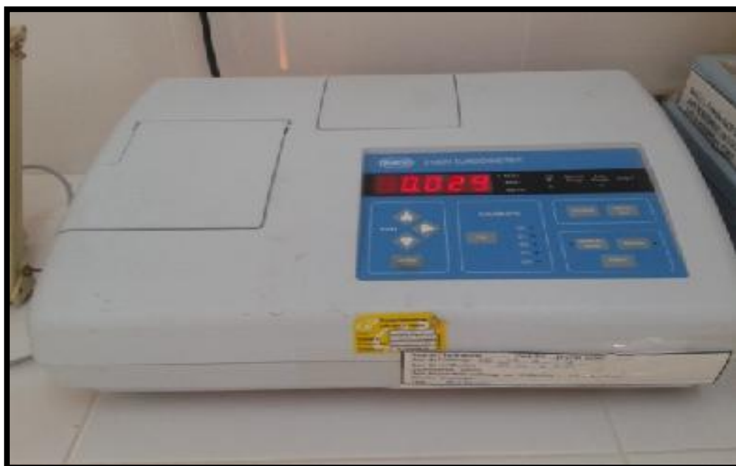
Figure 6. Turbidimètre (Chelli et Djouhri, 2013).
