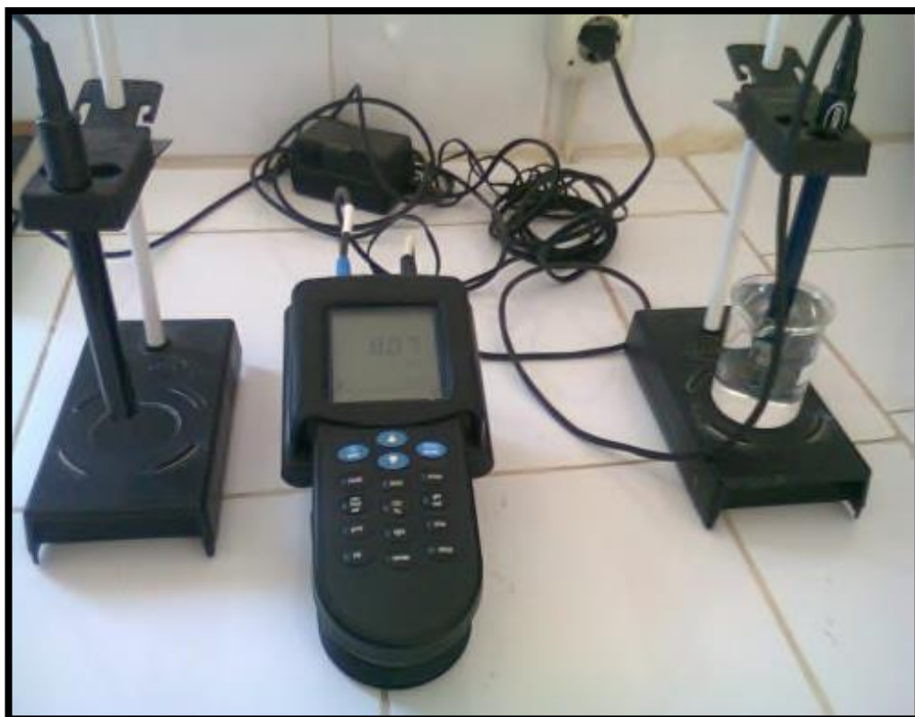
Figure 5. Appareil de mesure de la TDS, pH, conductivité, température et la salinité (Chelli et Djouhri, 2013)
