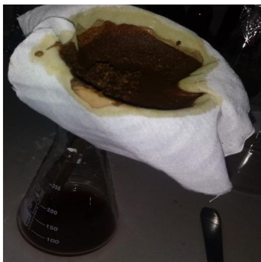
Résidu pariétal est mis dans le méthanol
