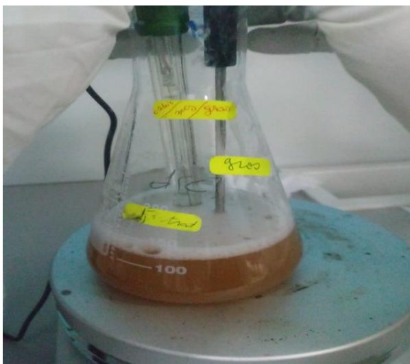
Neutralisation des filtras par l'acide acétique pur
