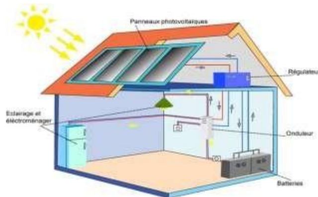
Figure I.16 : système PV autonome.
