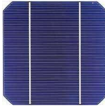
Figure II.6 : Cellule en silicium Mono-cristallin.
