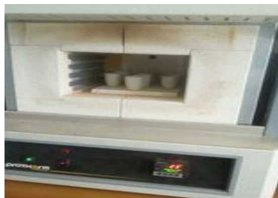
Figure 15 : les creusé dans le four à température 700°
