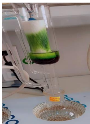
6. Nous plaçons le méthanol et la cartouche dans l'appareil d'extraction au soxhlet
