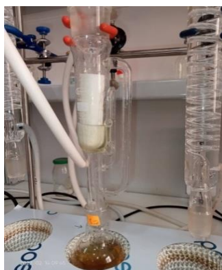
1. Nous plaçons l'eau distillée et la cartouche dans l'appareil d'extraction au soxhlet.
