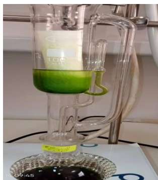
1. L'extraction par l'appareil de soxhlet.
