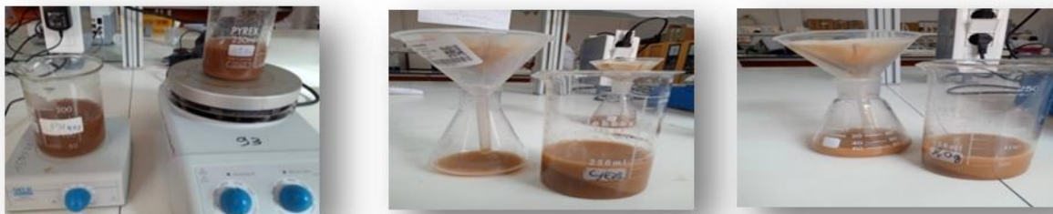
Figure 27 - Méthode d'analyse de sol par le pH mètre et Conductimètre. (Photo prise par Achour et Slimani, 2022)
