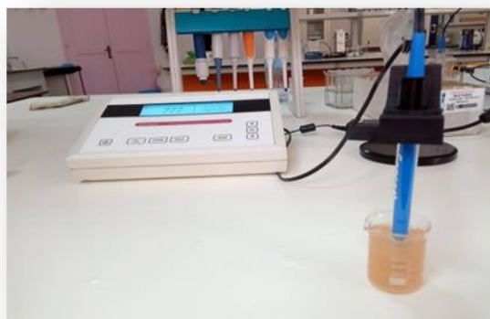
Figure 26-L'analyse de sol par le pH mètre et Conductimètre (Photo prise par Achour et Slimani , 2022)
