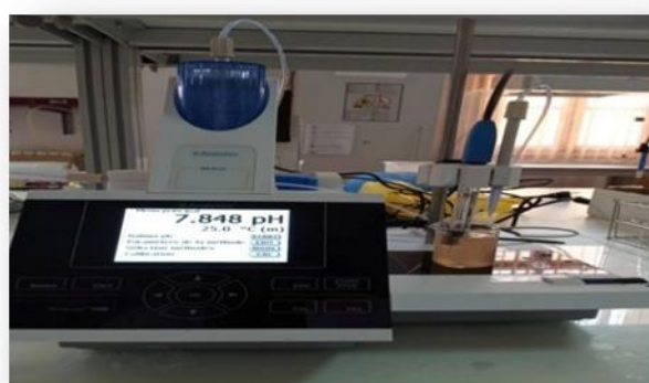
Figure 26-L'analyse de sol par le pH mètre et Conductimètre (Photo prise par Achour et Slimani , 2022)
