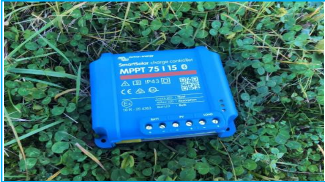
Figure I.21 : Schéma d'un régulateur MPPT (75I15).[14]
