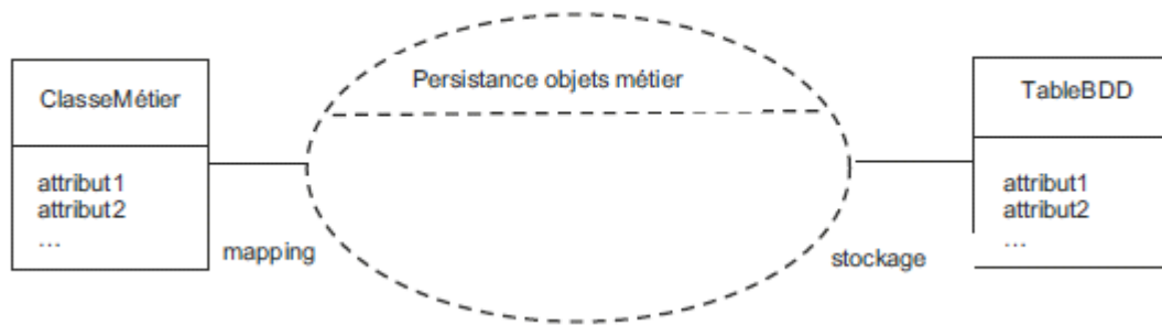
Figure I.16 : Exemple de représentation de collaboration d’instances par un diagramme de structure composite
