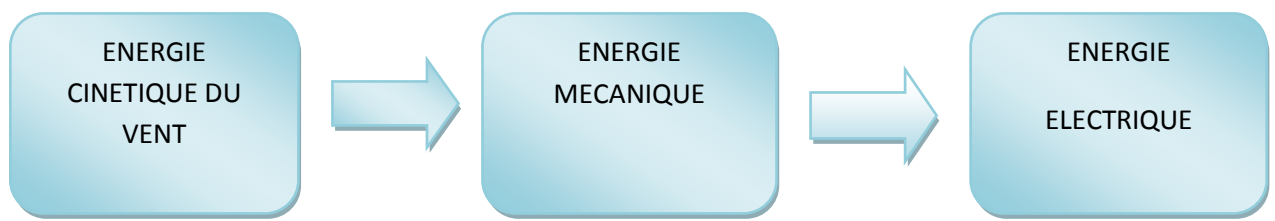
Fig 1.1 : Conversion de l'énergie cinétique du vent [10].
