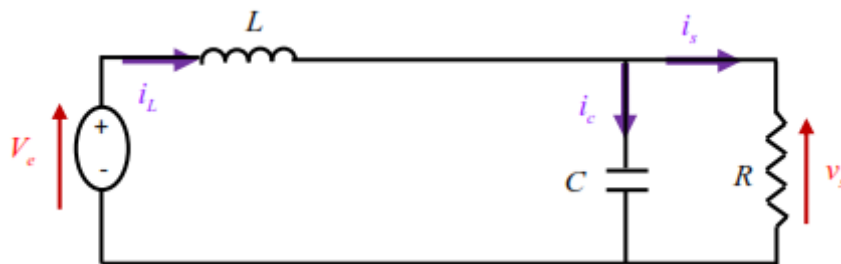
Figure II.9 : circuit équivalent de boost quand K est ouvert.
