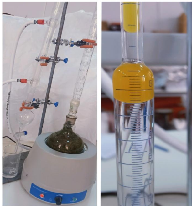
Figure2 Dispositif d'extraction d'huile essentielle de type Clevenger (photo personnel)
